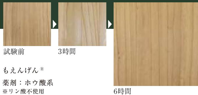
不燃木材の多くに使用されているリン酸系薬剤は水に溶けやすい性質があり、多湿の環境で(軒天・風除室・スケルトン天井)水分と結びつき木材表面に液だれ(潮解)を発生させます。
